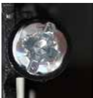
Daños causados por punta Philips en impronta Pozidrive.
