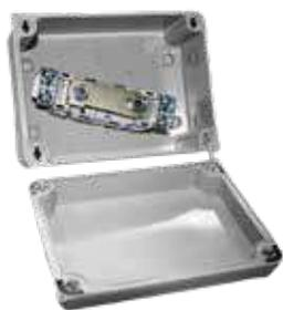
Seccionador de neutro In:160A en caja estanca sin conos. IP65, IK07. Precintable. Dimensiones interiores 153 x 110 x 65 mm. Cierre con tornillos 1/4 de vuelta.
