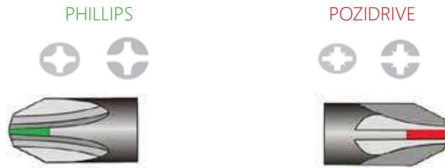
Las puntas Philips y Pozidrive de improntas cruciformes tipo DIN EN ISO 4757, se diferencian principalmente en el ángulo de ataque de la cruz. Mientras que el Pozidrive presenta unas paredes de apoyo casi rectas, el Philips presenta un ángulo de conicidad de la pala de apoyo. Esta geometría más recta del Pozidrive ofrece una mayor superficie de contacto punta-impronta y un ángulo de ataque más vertical, lo que mejora la transmisión de par respecto a un Philips.
