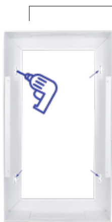
1- Fijar zócalo metálico a la pared
